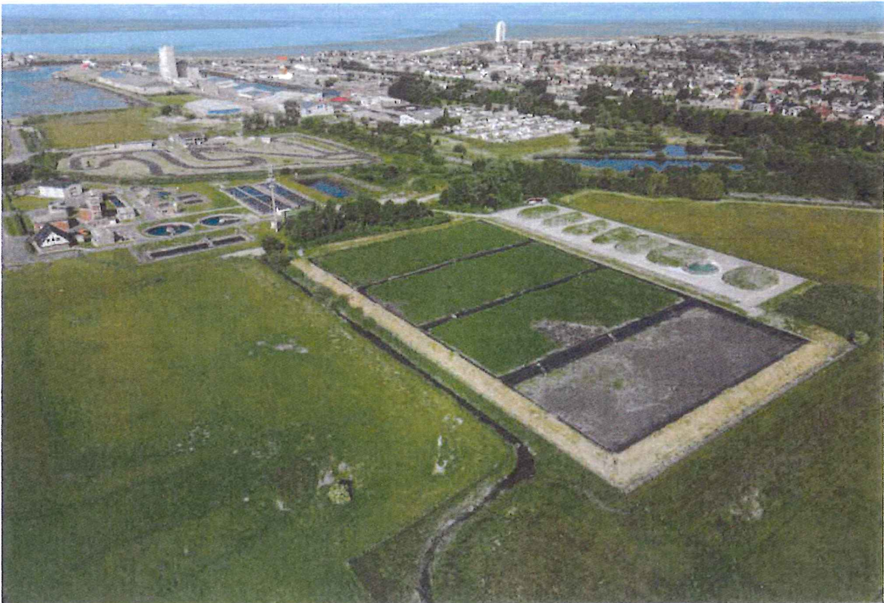
Bild 1: Kläranlage Büsum mit den vier Schilfbeeten der Klärschlammvererdungsanlage.
