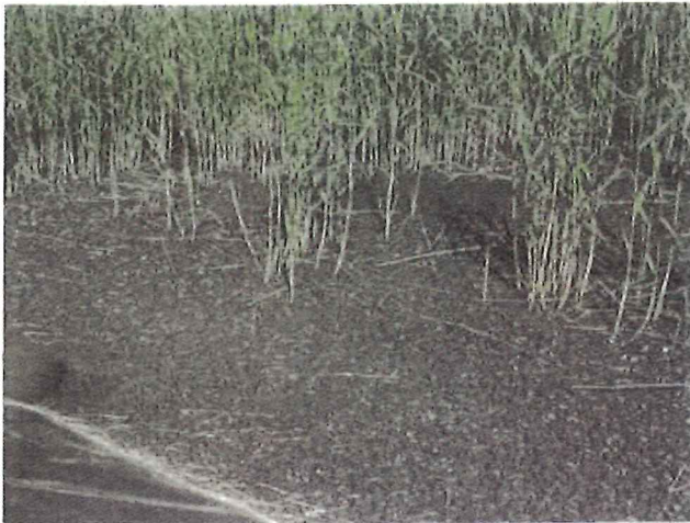
Bild 2: Entwässerter und vererdeter Klärschlamm im Schilfbeet. Durch biologische Umbauprozesse wird die verbleibende Restmenge im Vergleich mit mechanischen Entwässerungsverfahren deutlich reduziert.
